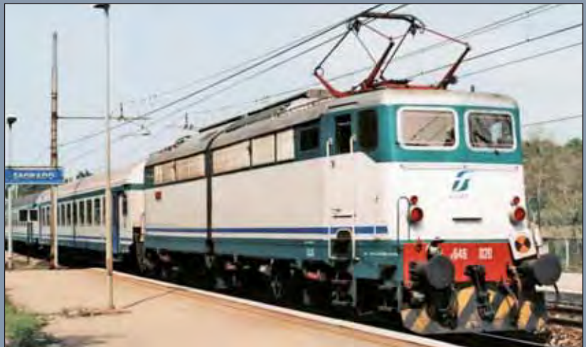
Locomotiva elettrica E 646.020, livrea XMPR, con fanaleria modificata e aria condizionata, assegnata al Deposito di Trieste. Electric Locomotive FS E.646.020 in XMPR livery, with modified front lights and air conditioning. Trieste Depot. E-Lok E.646.020 der FS in XMPR-Lackierung, mit geänderter Beleuchtung und Klimaanlage, zugeordnet zu Bw Trieste.
