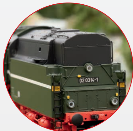
Mit Einheitstender 2'2'T34 umgebaut auf Ölfeuerung.
