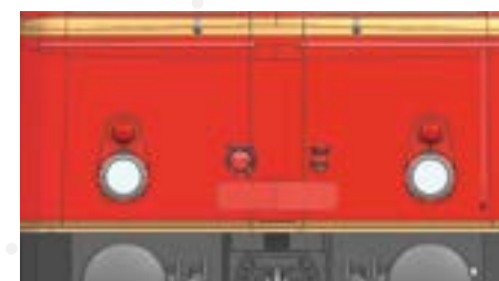
Separat angesetzte Steckdosen und Betriebsnummer
