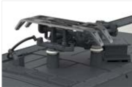
Neu konstruierter Stromabnehmer mit unsichtbarer Befestigung
