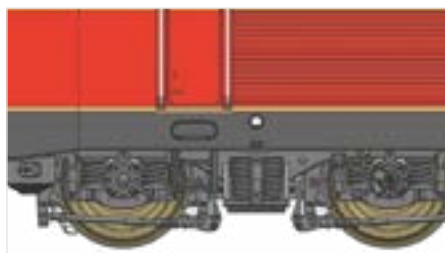
Drehgestelle und Achslagerdeckel mit filigraner Gravur
