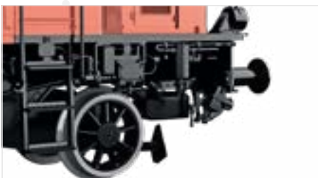
Aggregate und Leitungen freistehend ausgeführt
