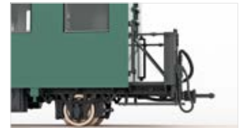
Bühnenbereich mit nahezu unsichtbarer Kupplungsbefestigung
