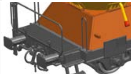
Detaillierte Rangiererbühne mit durchbrochenem Gitter
