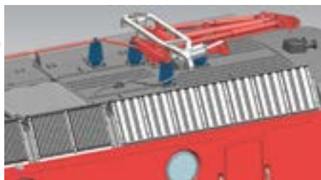
Separat angesetztes Kabel zu den Stromabnehmern
