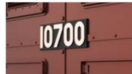
Erhaben ausgeführte Loknummer
