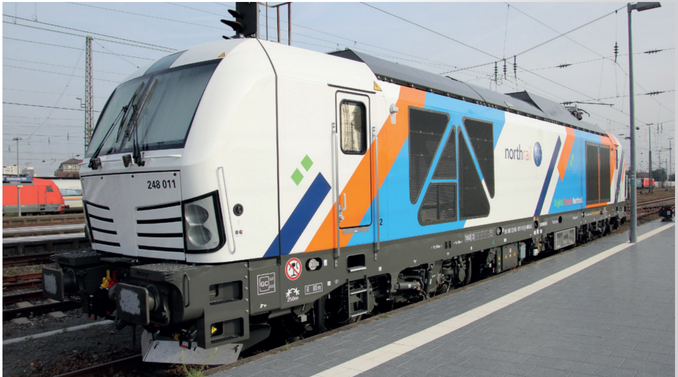
Dual Mode Lokomotive 248 014-3 der Northrail GmbH Dual mode locomotive 248 014-3 of the Northrail GmbH • Mit freundlicher Unterstützung von / Licensed by Northrail GmbH
