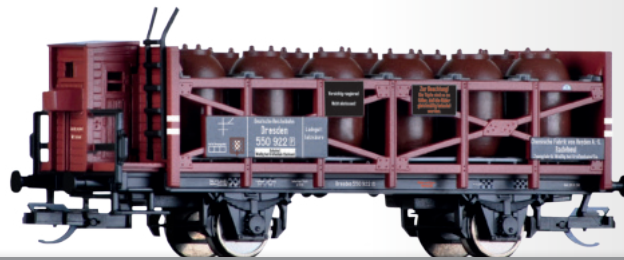
Säuretopfwagen „Chemische Fabrik von Heyden“, eingestellt bei der DRG Acid pod car „Chemische Farabrik von Heyden“ of the DRG
