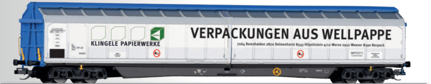
Schiebewandwagen Habnis „Klingele Papierwerke“ der DB AG Sliding wall box car Habnis “Klingele Papierwerke” of the DB AG • Mit freundlicher Unterstützung / Licensed by Klingele Papierwerke GmbH & Co. KG
