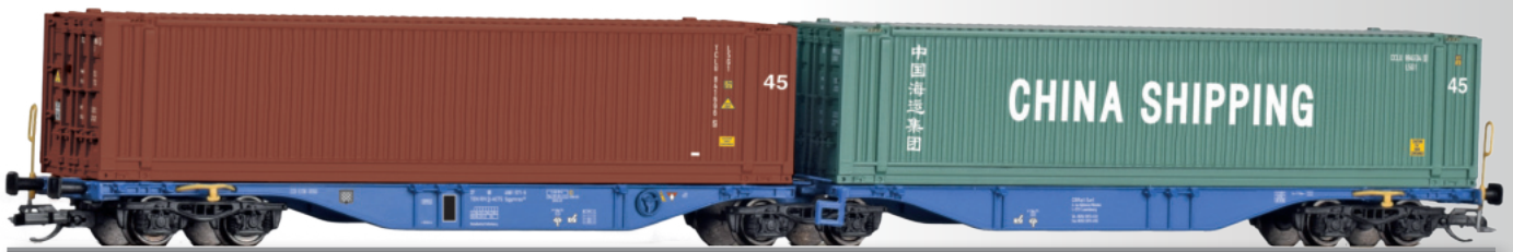
Containertragwagen Sggmrss der ACTS, beladen mit zwei 45'-Containern Container car Sggmrss of the ACTS with load
