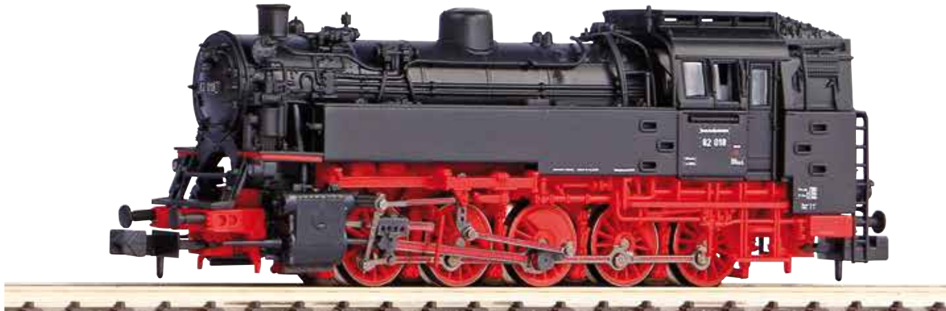
☒ 40104 Dampflokomotive BR 82 DB Ep. III, mit Oberflächenvorwärmer
