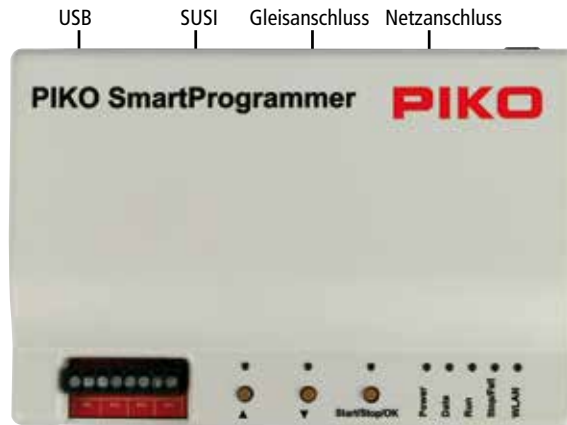
Vier Anschlüsse für Sensoren (Pendelautomatik)
