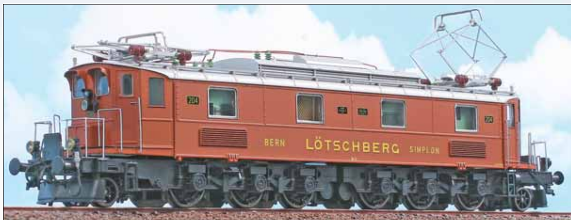
Locomotiva elettrica Be 6/8 204 BLS allo stato di origine, con avancorpi e grandi bocche circolari, senza sabbie esterne. Electric locomotive Be 6/8 204 BLS in original state, with frontal bonnets and big round bushings, without external sandboxes. E-Lok Be 6/8 204 BLS im Ursprungszustand, mit Vorbauten und großen runden Achslagern, ohne äußere Sandkasten
