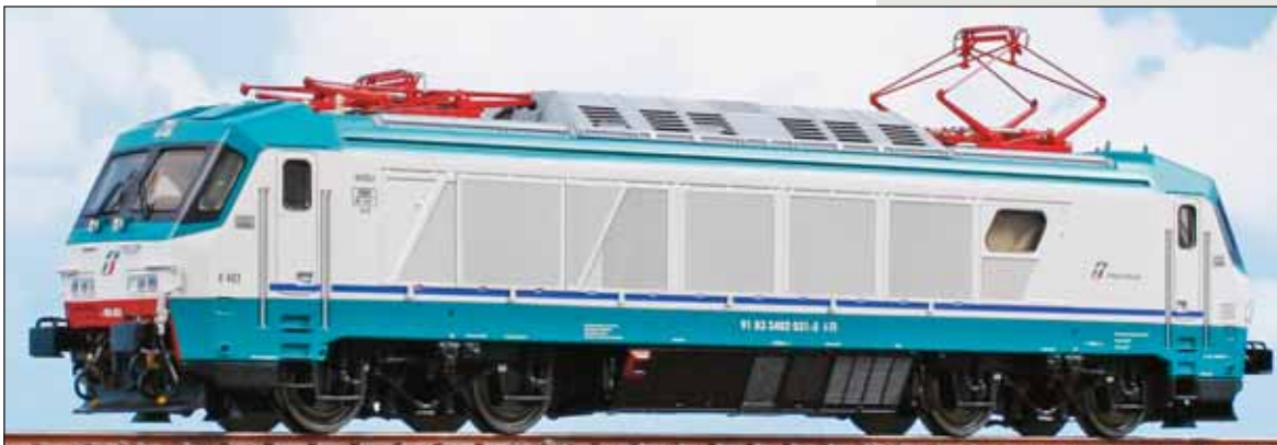
Locomotiva elettrica E.402.031 di Trenitalia, in livrea XMPR con connettori per il comando lateralizzato per le porte del treno. Electric locomotive E.402.031 of Trenitalia, in XMPR livery with sockets for independent side control of the train doors. Lokomotive E.402.031 der Trenitalia, in XMPR Lackierung, mit Steckdosen für die seitenabhängige Steuerung der Zugtüren
