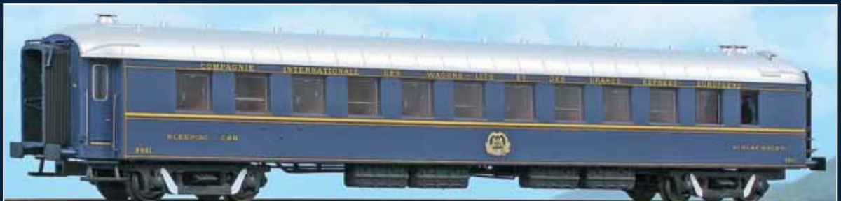
Carrozza letti Tipo Ub 3951, in livrea e carrelli originali CIWL, di costruzione EIC, nello stato di servizio degli anni sessanta. Sleeping car Type Ub 3951, livery and bogies original CIWL, built by EIC, in service condition from the 1960s. Schlafwagen Typ Ub 3951, Lackierung und Drehgestelle original CIWL, gebaut von EIC, Betriebszustand aus den 1960er Jahren.
