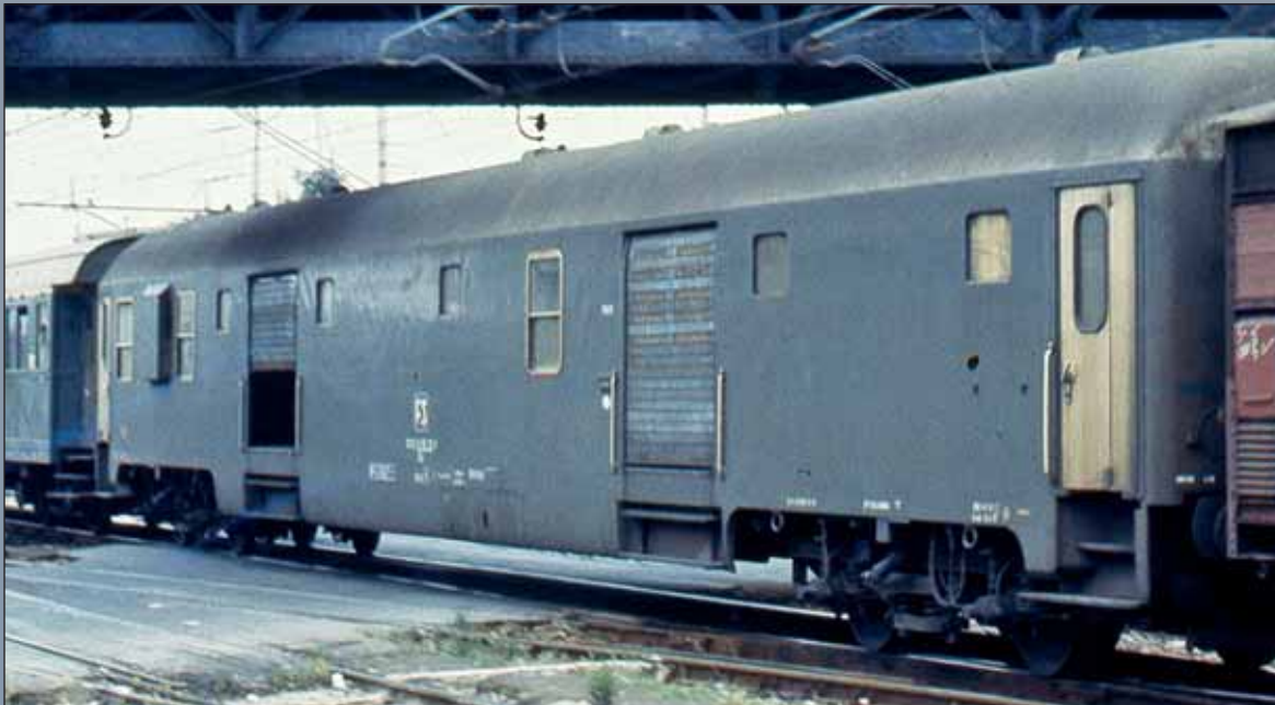
Bagagliaio posta FS Tipo UIC-X 1970, carenatura grande e porte in lega, livrea grigio ardesia. FS luggage and postal van Type UIC-X 1970, large fairing and alloy doors, slate gray livery. Gepäck-Postwagen der FS Typ UIC-X 1970, große Verkleidung und Alu-Türen, schiefergraue Lackierung.
