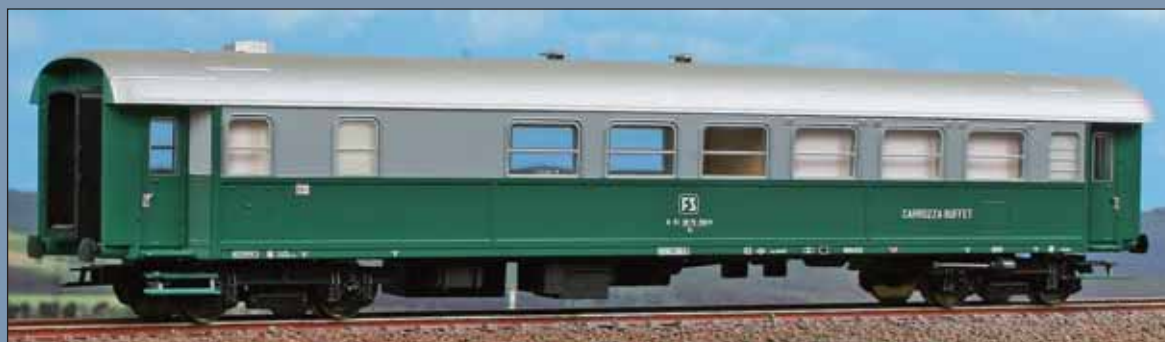
Carrozza Buffet-bar Tipo 1951R delle FS nella livrea verde e grigia. Carrelli Tipo FS 24 . Italian Railways Type 1951R Buffet-bar car in gray and green livery. Type FS 24 bogies. 1. Klasse Büffet-Barwagen Typ 1951 R der FS in grau/grüner Lackierung, wie für einige Jahre im "Alpen-Express".
