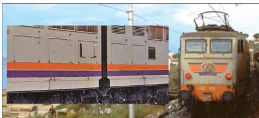
Locomotiva E646 050 in livrea "Navetta", tetto scuro, senza gocciolatoio e con tutti i portelli lato AT bassi.
