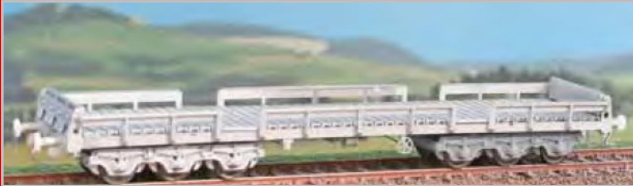
**6-achsiger Flachwagen Bauart Sa der FS, Epoche IV , für den Transport von Blechrollen und Stahlrollen**
