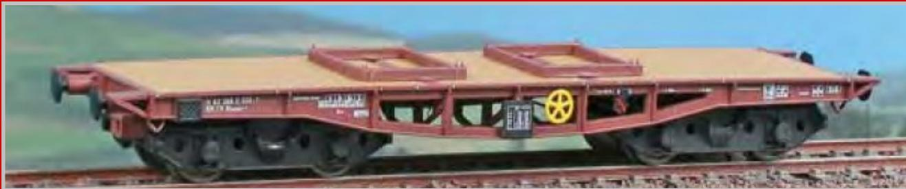
**Schwerlastwagen Bauart Rlmpmp-t der
