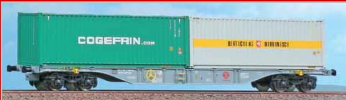
**Containertragwagen Bauart Sgnns 60,
