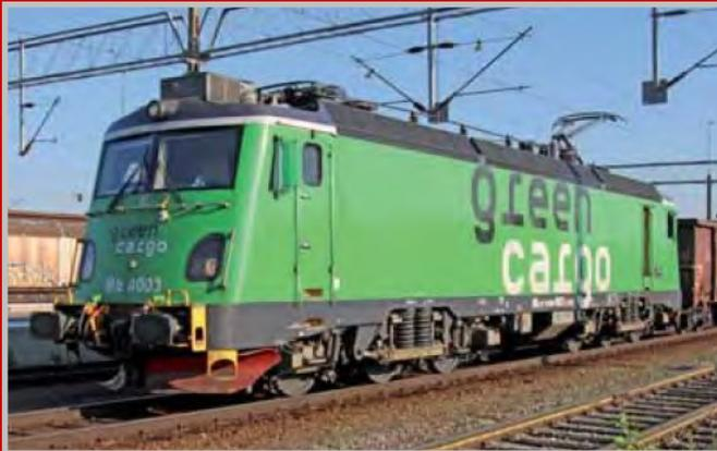
**E-Lok Bauart Transmontana der dritten Bauserie
