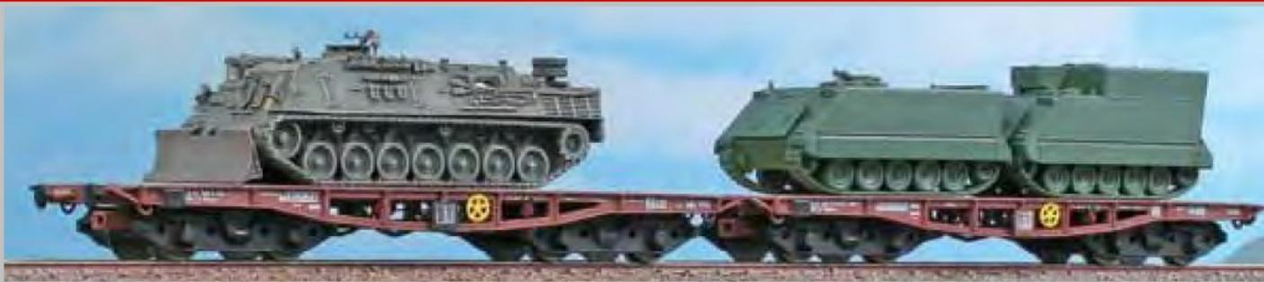
Set mit 2 Schwerlastwagen Bauart Rlmpmp-t mit Panzerbeladung
