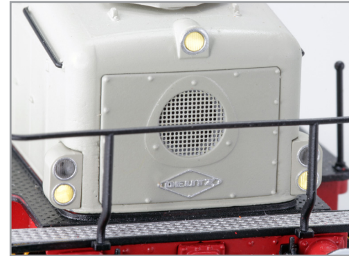
Durchbrochenes Lüftergitter als Messinggätzteil
