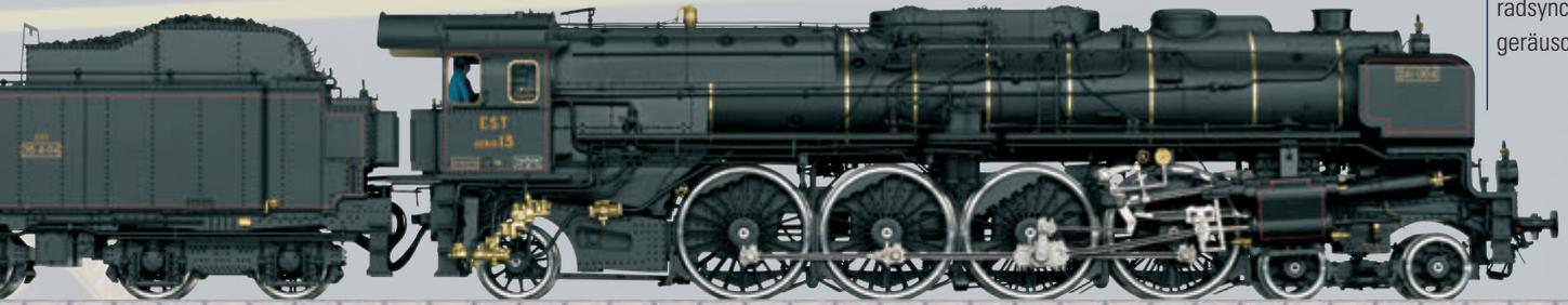
Fahrwerk, Aufbauten, Kessel etc. aus Zinkdruckguss, Ansetzteile aus Messing.
