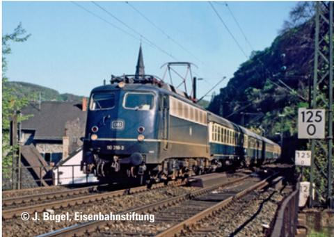
**Vorbild:** Einheits-Elektrolokomotive 110 318-3 der Deutschen Bundesbahn (DB). Spitzname „Bügefalte“. Kobaltblaue Grundfarbgebung. Ausführung mit Doppellampen, Kunststoffregennirren über den Frontfenstern und Führerstandstüren, „durchgehendes“ Lüfterband aus 7 „Klatte-Lüftergittern lang“ und stirnseitige Handgriffe. Ohne Schürze und ohne Pufferverkleidung. Zustand um 1983.
