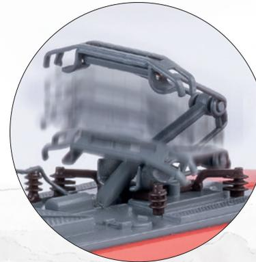
*Mit digital heb- und senkbaren Dachstromabnehmern
