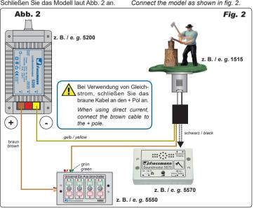
Zum einfachen Ein- und Ausschalten des Modells, verwenden Sie einen Schalter (z. B. Art. 5550) (Abb. 2).
