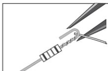
7. Anschließend biegen Sie das senkrecht hochstehende Ende des Widerstandes um.
