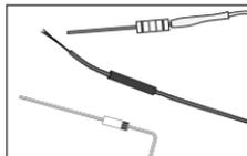
10. In gleicher Weise verfahren Sie mit den braunen Kabeln, dem schwarzen Schrumpfschlauch und der Diode.
