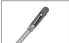
3. Dann wird der LED-Leuchtkörper im Lampenschirm platziert und eingeklebt. Klipsen Sie nun das Lampenglas auf den Lampenschirm.
