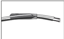
1. Die beiden Kabelenden der jeweiligen LED werden durch einen Lampenschirm hindurch gefädelt.
