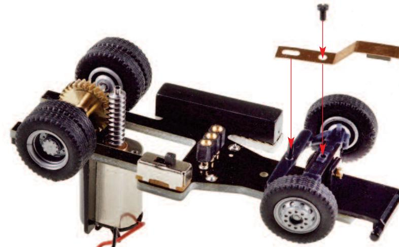
17. Die Schraube der Lenkstange komplett zudrehen und dann wieder ca. eine Umdrehung öffnen.
