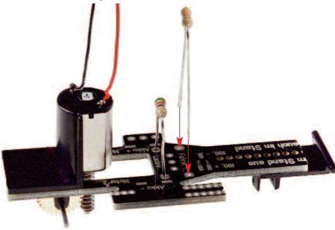
Fahrwiderstand bei »Niederquerschnittsreifen« (2,0 Ohm)
