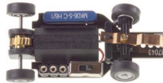
10. Die beiden Motorkabel auf die Platine löten.
