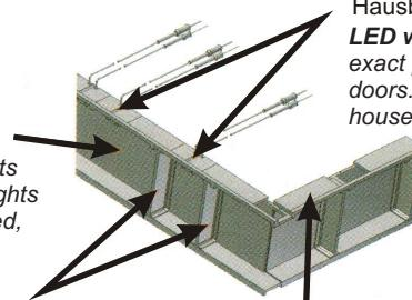
**LED mit Kunststofffassung** verschiebbar zur punktgenauen Positionierung über den Fenstern und Türen. Auch passend für Lichtboxen der Hausbeleuchtung Art. 6005.
