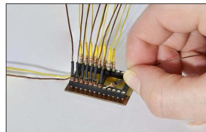
Die geniale und praktische 12-polige **Viessmann-Steck-Verteilerleiste** Art. 6049 verbindet bis zu 12 Stromverbraucher. Ohne Stecker, ohne Schraubklemmen und ohne Löten.
