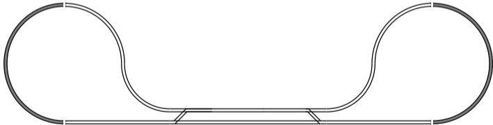
Figure 8 : Boucles de retournement aux extrémités d'une voie en forme d'os de chien.
