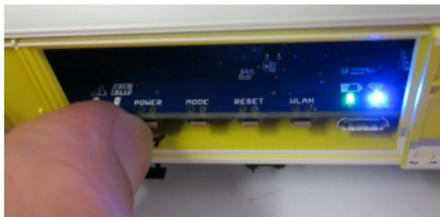
Um den PIKO H0 Messwagen auszuschalten, drücken Sie die „POWER“ Funktionstaste für sieben Sekunden. Wenn die rote LED anfängt zu blinken kann die Taste losgelassen werden und der Wagen schaltet sich aus.
