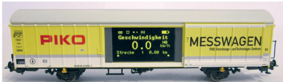
Hinter den Schiebetüren des PIKO H0 Messwagens verbergen sich auf der einen Seite das grafische Display und auf der anderen Seite (der Rückseite) die Funktionstasten sowie die USB-Buchse.
