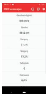
Auf dem Hauptbildschirm werden alle verfügbaren Daten wie Geschwindigkeit, Wegstrecke, Steigung und Neigung sowie Fahrstufe der belauschten Lok, Gleisspannung und Akku-Ladezustand angezeigt.
