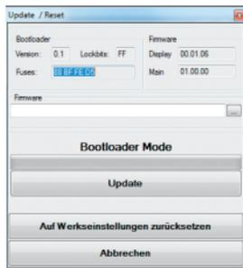
Im PIKO Webshop befinden sich auf der o.g. Seite Firmwaredateien für den PIKO H0 Messwagen, die regelmäßig aktualisiert werden. Diese Dateien heißen „MesswagenComplete\_Vx.xx.xx.pfw“. Die „x“ stehen für die Versionsnummer der Firmware. Laden Sie für ein Update immer die aktuellste Firmware mit der höchsten Versionsnummer herunter, da diese die neuesten Funktionen und Korrekturen enthält. Es ist aber auch möglich, eine ältere Firmware zu verwenden.
