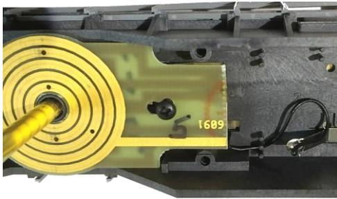
Nun kann die Leiterplatte wieder aufgeschraubt werden. und sie können das Kabel an das nun offene Gleisende Löten.
