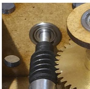
Nun können sie die Welle mit Schneckenrad auf den Motor aufsetzen und verschrauben, der Motor wird nicht ganz fest, sodass er sich leicht bewegt und der Getriebespanner seine Arbeit verrichten kann.
