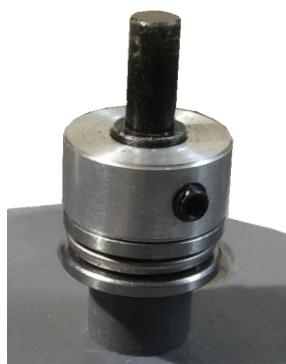
Nun setzen sie die Bühne in die Grube ein und stecken auf die Achse das Axiallager 6x14x5. Die Bühne wird nun mit dem Alustellring (6x14x7) fixiert.
