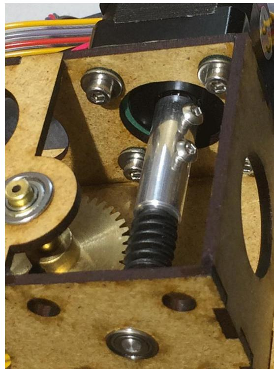
Als nächstes können sie den Motor in die Box einsetzen. Schrauben sie den Motor mit den mitgelieferten Schrauben fest. Die Moosgummimunterlegscheiben werden dabei mit dem Moosgummi zum Holz hin geschraubt.
