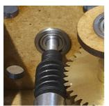
Nun können sie die Welle mit Schneckenrad auf den Motor aufsetzen und festschrauben, es sollte ein Spalt von ca. 1mm zwischen Welle und Motor bleiben.
