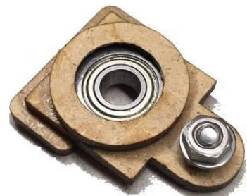
Nun können sie die Senkkopfschraube einbringen, diese wird mit einer Mutter befestigt, dann kommt eine Unterlegscheibe
