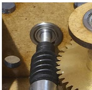
Nun können sie die Aluwelle mit Schneckenrad auf den Motor aufsetzen (noch nicht fest schrauben). Setzen sie das Flanschlager in die Getriebebox ein, der Flansch sitzt hier im Inneren der Getriebebox.
