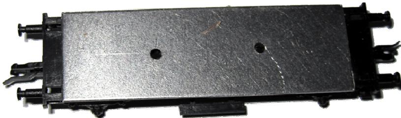
Nun können sie in der Mitte des Wagenunterteils 2 Löcher Bohren. Diese haben einen Abstand von 22mm und einen Lochdurchmesser von 2,5 bis 3mm.
