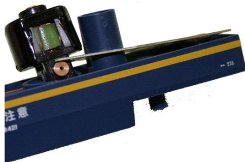
Jetzt können sie den alles wieder zusammenbauen. Als erstes wird die Platine mit dem Motor eingesetzt.
