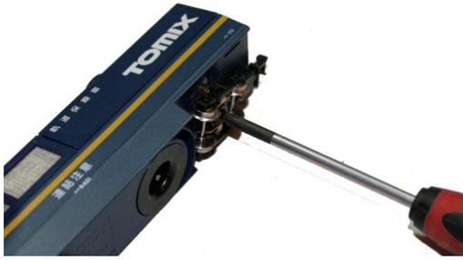
Als erstes muss der Gleisreinigungswagen aufgeschraubt werden, dann können sie alle Teil vorsichtig entfernen. Wenn sie vorher das Staubsaugerrad mit dem dafür vorgesehen Werkzeug (liegt dem Reinigungswagen bei) entfernen, lässt sich der Motor leicht abheben. Dabei müssen sie den Wagen soweit zerlegen, bis die Leiterplatte abzunehmen geht.
