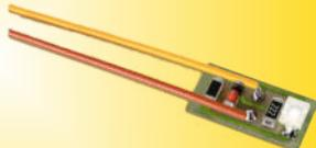
**Platine mit zwei LEDs für Hausbeleuchtung:**
