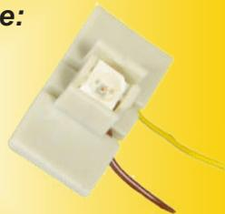
**Platine mit einer LED für Hausbeleuchtung:**
