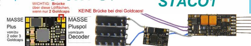
STACO1 10 x 7,3 x 2 mm (CAD 2:1 vergrößert)    STACO1 (Mitte) an Miniatur-Sound-Decoder MS490N und 2 Mini-Goldcaps in Serie geschaltet (Maßstab 1:1)
