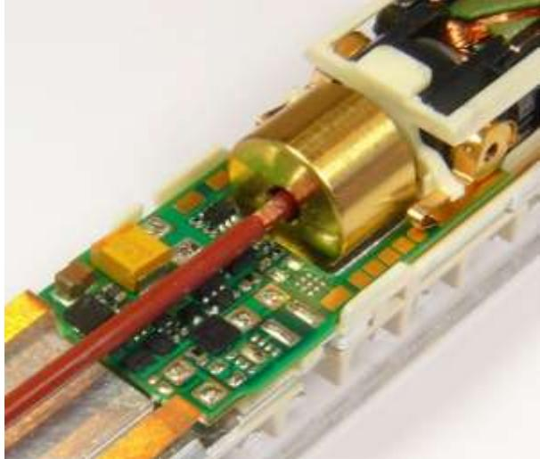
So wie auch in der Kato Anleitung, wird die Kardanwelle aus der Kardanschale des Drehgestells herausgezogen. Das Gleiche passiert anschließend motorseitig. Der ZIMO Decoder MX605N wird mit dem gelben Tantal-Kondensator nach „oben“ (zum Betrachter) eingeschoben. Der Zusammenbau der Kardanwelle und des Wagengehäuses erfolgt in umgekehrter Reihenfolge.
