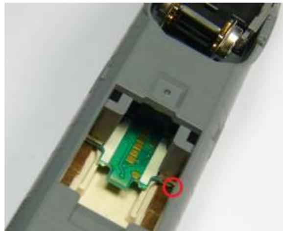
Der ZIMO Decoder MX605SL wird mittels einer Pinzette in den Schacht eingesetzt. Er kommt zwischen den Kontaktblechen zu Liegen. Stellen Sie sicher, dass der Decoder ganz nach vorne geschoben wird.
