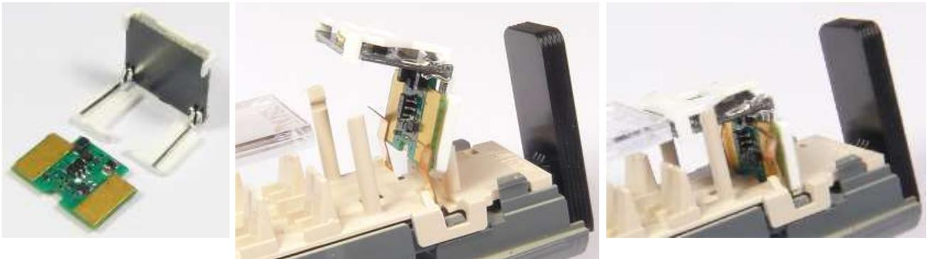
Der ZIMO Decoder MX605FL wird auf die Decoderhalterung gelegt. Beide werden anschließend zwischen die Kontaktbleche und die Kunststoffhalterung geschoben, bis die Decoderhalterung in der Wageninneneinrichtung einrastet. Danach sollte die Funktion getestet werden, bevor das Wagengehäuse montiert wird.
