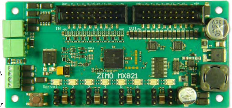
LEDs zur Anzeige der Stellungen der Servo-Weichen Servo-Ausgänge 1 ... 8 (Steuerleitung, 5V, MASSE)
