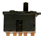
**Unterflur-Weichenantrieb** kann für alle ROCO-Gleissysteme verwendet werden. Niedere Stromaufnahme, Endabschaltung, 4 1-polige Umschalter. Kann auch waagrecht eingebaut werden. Maße ca. 60 x 27 x 45 mm
