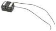
Mit diesem Lautsprecher-Set ist es möglich, einen Sound nachzurüsten. Komplett mit Resonanzkörper und Anschlusskabeln. Ideal auf Zimo- Sounddecoder abgestimmt. Abmessungen: 10 x 15 x 9 mm
