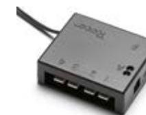
Wird zum Anschluss von diverserem Zubehör (Weichen, Licht, Signale ect.) an die neuen Trafos benötigt. Eingang ist eine Koaxialbuchse, Ausgänge sind die Anschlussmöglichkeiten über eine Lüsterklemme und vier 3-polige Steckerzonen und ein fixes Kabel mit Koaxialstecker zu einem Regel- oder Digitalgerät.
