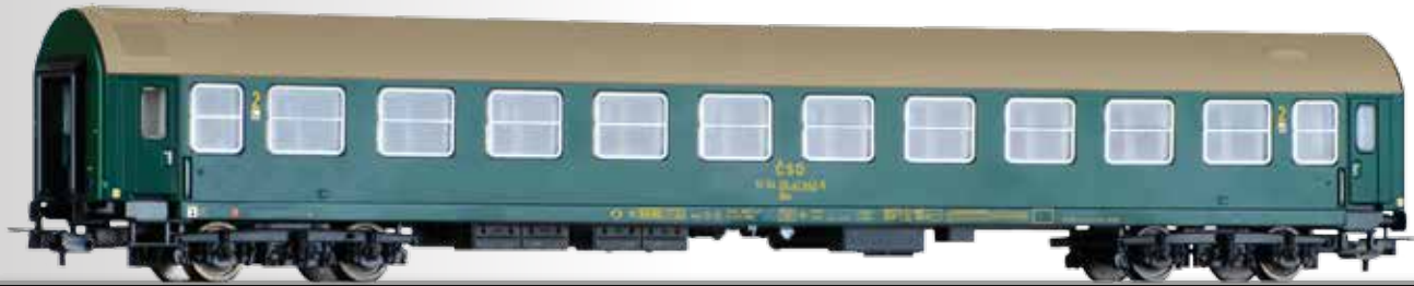
Reisezugwagen 2. Klasse Bm, Typ Y, der ČSD 2nd class passenger coach Bm, type Y, of the ČSD
