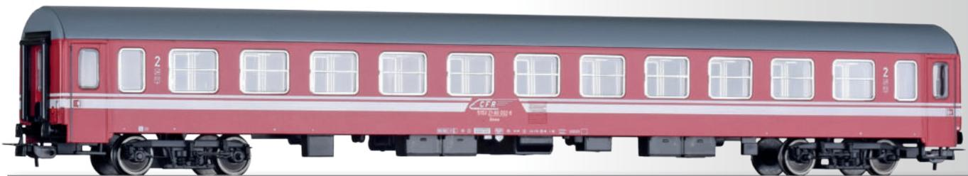
Reisezugwagen 2. Klasse Bmee, Bauart Bautzen, der CFR
