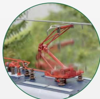
Für den reibungslosen Grenzübergang und somit auch den Wechsel der Stromnetze zwischen Deutschland und Frankreich, besitzt die BR 181.2 zwei unterschiedliche Schleifstücke an ihren Stromabnehmern. Somit gehört sie zu den Zweifrequenzlokomotiven.
