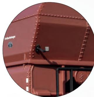
Separat angesetzte Signalstützen an den Stirnseiten
